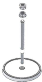
Löcher für die Befestigung der Stockschrauben ausreichend vorbohren (Sparren 8 mm)
